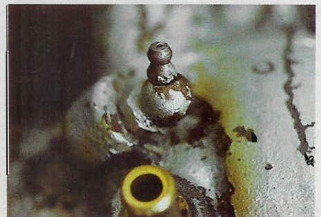
Erkennungszeichen: Ein Schmiernippel verrät offene Lager. Umbauten sind möglich
