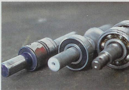
Von rechts nach links: offenes Wellenlager, dauergeschmiertes, geschlossenes Lager, Kompaktwelle
