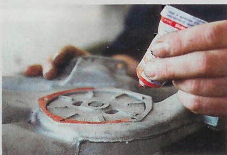
...dann die Dichtflächen zusätzlich mit nicht aushärtender Dichtmasse versehen, Dichtung...
