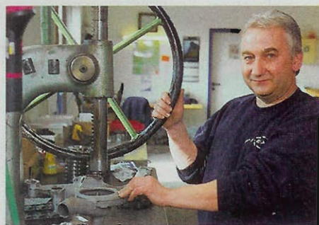
...Gefühl per Handpresse über die Pumpenwelle und in das Gehäuse gedrückt. ein Teil sitzt fest im...
