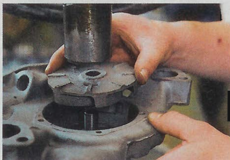
Vorsicht und die Mutter der Porzellankiste: Beim Aufpressen kann das Guss-Schaufelrad brechen...
