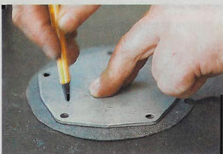
Das kleine Schrauber-Einmaleins: neue Gehäuse-deckeldichtung ausschneiden, Löcher stanzen...
