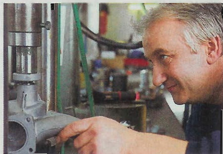
...auf und presst ihn vorsichtig soweit auf die Pumpenwelle, wie er zuvor gesessen hat. Passt...
