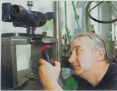
Sorgfalt gefragt: Wird das Pumpengehäuse beim Auspressen der Pumpenwelle nicht an der...
