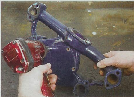
Mit einem Druckluftschrauber sind die Schrauben des Stirndeckels schnell gelöst und der Blick auf...
