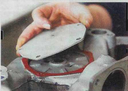
...auflegen, Deckel drauf, vorsichtig festziehen und dann nur noch lackieren. Im Normalfall sollte die...
