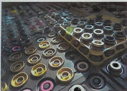
Ohne das richtige Teil geht nichts: eine der Rem-Ex-Gleitringdichtungsschubladen. Das zweiteilige...
