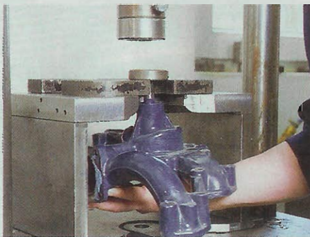
Beispiel Cadillac-V8-Pumpe: Nach dem Entfernen der Riemenscheibe kann deren Flansch einfach...
