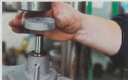
Und jetzt zur Abwechslung mal andersrum: Walter Bienek setzt den Flansch der Riemenscheibe...
