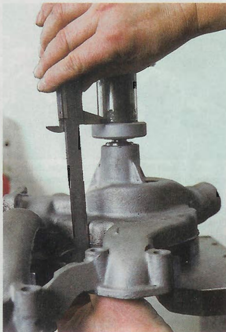
...dieses Maß nicht, läuft später der Keilriemen logischerweise nicht in der Flucht
